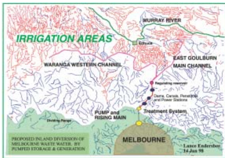
План профессора Эндерсби включает строительство трубопровода, начинающегося в 25 километрах на север от центра Мельбурна, и системы насосных станций для переброски воды через Большой разделительный хребт в речную систему запада страны.
